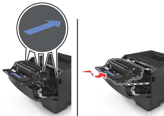
**7** Inserire la cartuccia di toner nella stampante allineando le guide laterali della cartuccia con le frecce sulle guide laterali all'interno della stampante.
